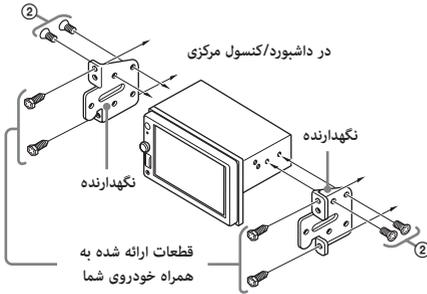
هنگام نصب این دستگاه در نگهدارنده از قبل نصب شده در خودرو، از پیچ های ارائه شده (2) در حفره های مناسب پیچ در خودرو استفاده کنید:
